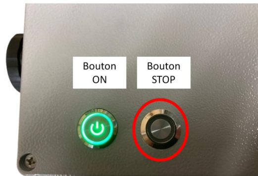
Figure 22: Bouton ON est allumé, le bouton stop n'est pas engagé
