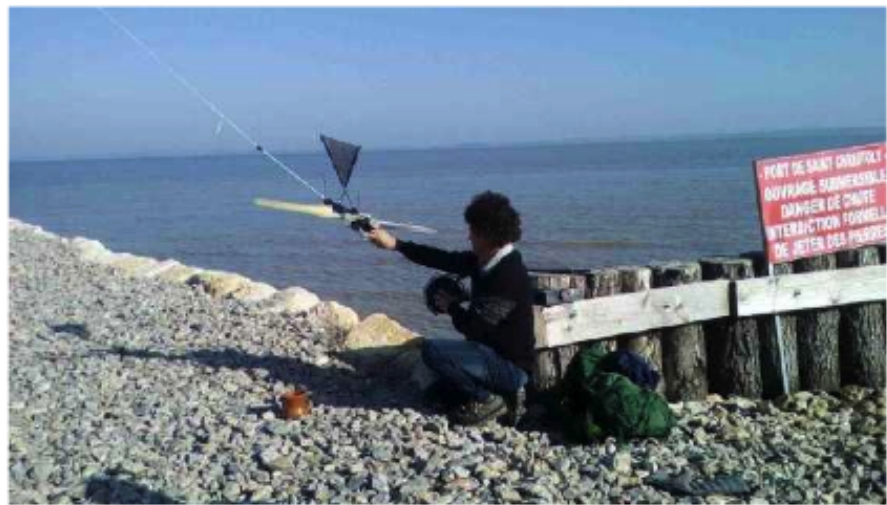
Des essais réussis pour l'éolienne volante (portable et qui tient dans un sac à dos). PHOTO PNC
